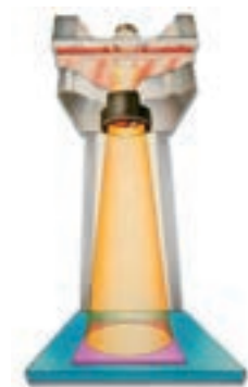
Uma fonte de luz é focalizada e projetada por meio de uma coluna em movimento de óleo.
