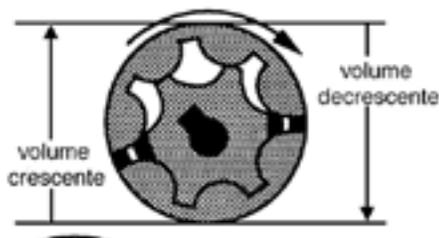
São motores de baixa velocidade e alto torque, utilizam o conceito internamente de rotor gerotor com vantagens construtivas. O rotor, elemento de potência não orbita, somente gira. Esta função é executada pela orbitação do anel externo, eixo feito de uma única peça.
